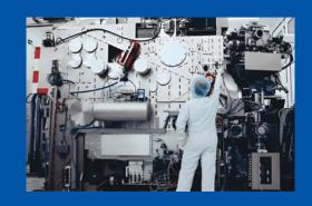
光刻機是一種用於半導體製造的精密設備,其主要功能是將設計 好的電路圖案精確地轉移到矽晶圓上。
