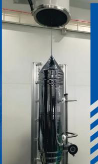
生產芯片所需要的矽純度要求達到 99.9999%,高純度的單晶矽棒是利用沙子、石英等材料經過反復多次提純,在熔 爐中整形或提拉而成。
