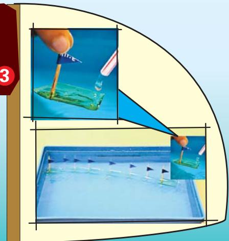
在膠盆內注入半滿的水。將適量酒精倒進紙杯內，用飲管吸出酒精並滴下數滴在小船的尾部。把小船輕輕放在水面上，放手後小船便會自動向前行駛！
